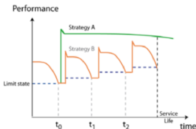
Figure 1.1 Comparaison de la durée de vie et de la performance d'une réparation en BFUP (Stratégie A) avec une réparation en BO (Stratégie B) [9]
