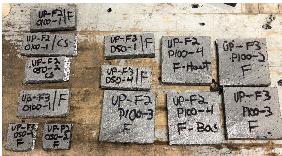
Figure 3.10 Tranches minces non préparées extraites des spécimens de flexion et de traction pour évaluer l'orientation et la densité des fibres
