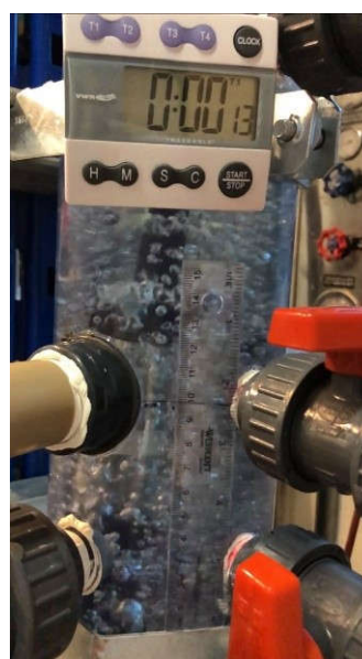
(b) Vitesse de bulle d'air > 14 cm/s
