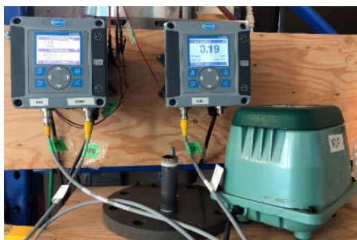
Contrôleurs des sondes de pH, de redox, d'OD et aérateur
