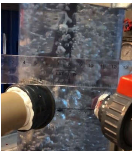
(a) Taille de bulle d'air : 2 – 5 mm
