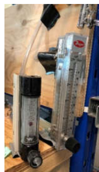
Set-up pour abaisser la pression du flux d'air
