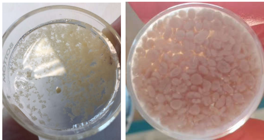
Figure 5-11 Liqueur mixte échantillonnée à la phase d'aération
