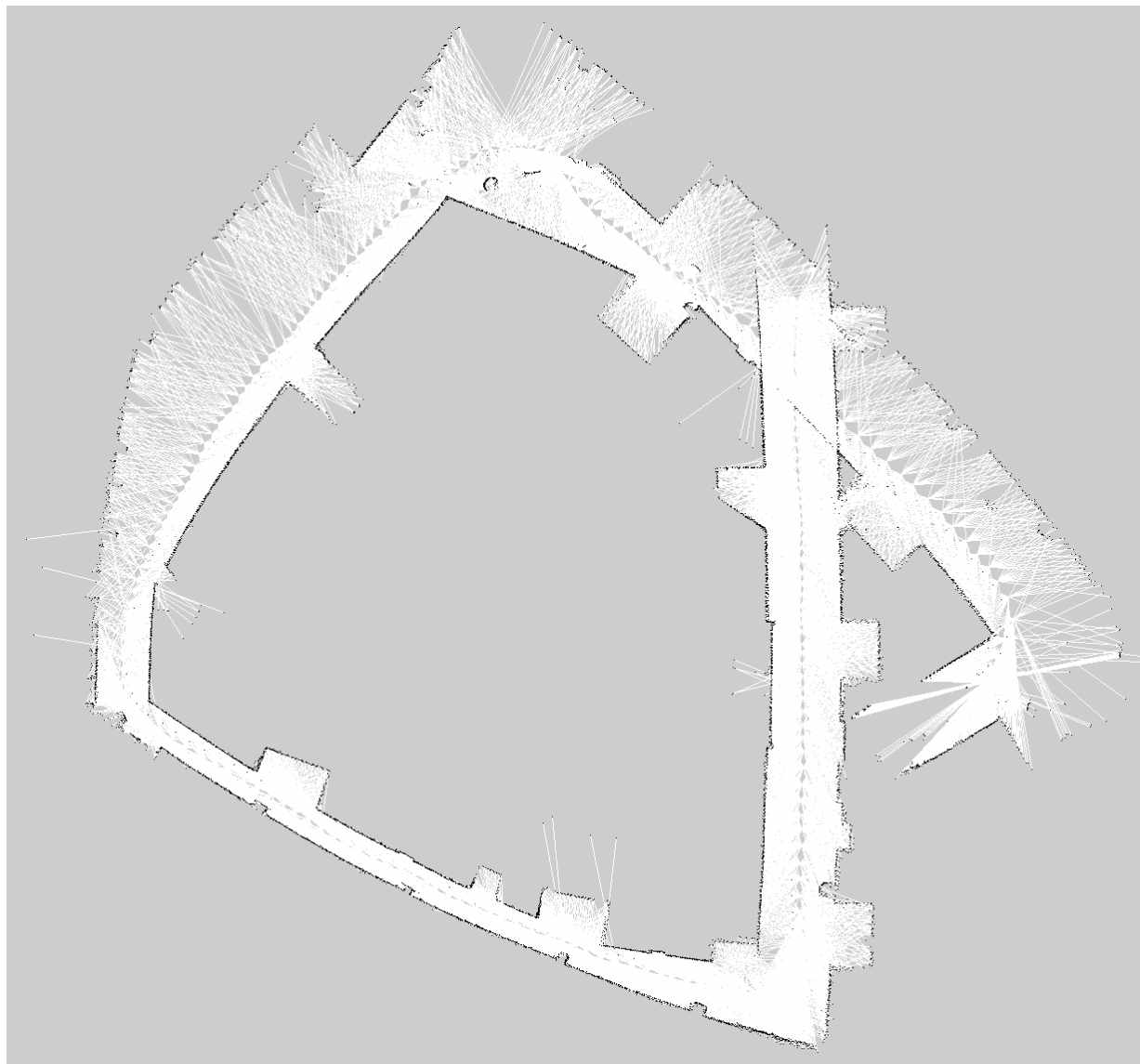
Figure 5.9 Cartographie du premier étage du bâtiment Lassonde avec une fusion de donnée : télémètre laser (10%), ultrason et caméra Kinect
