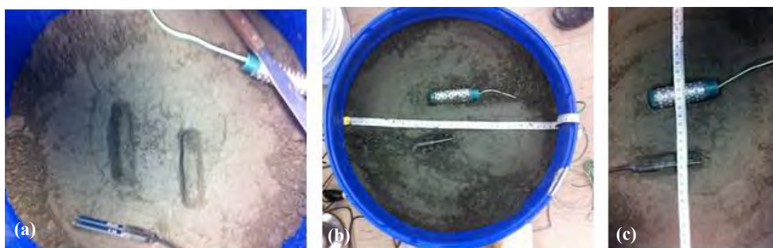
Figure 3.4 : Installation des sondes de teneur en eau (EC5) et de succion (Watermark-Irrrometer). (a) Espaces creusés au centre de la couche afin (b) d'y placer les sondes. (c) espacement de 5 cm entre les deux sondes.
