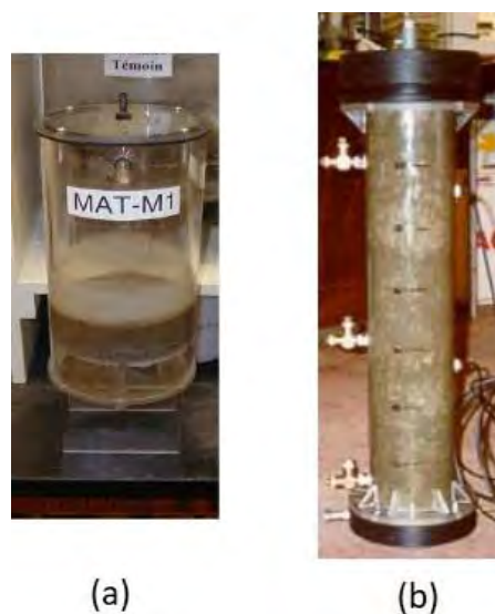
Figure 2.3: Dispositifs expérimentaux régulièrement utilisés pour les essais cinétiques (tiré de Villeneuve, 2004). (a) : Essais en cellule humide. (b) : Essais en colonne
