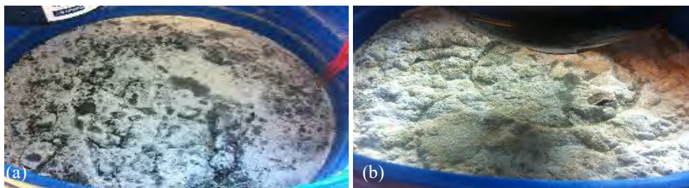
Figure 4.19 : Couche de sels à la surface des colonnes : (a) : fin du 1er cycle ; (b) : début du 3e cycle colonne C60.
