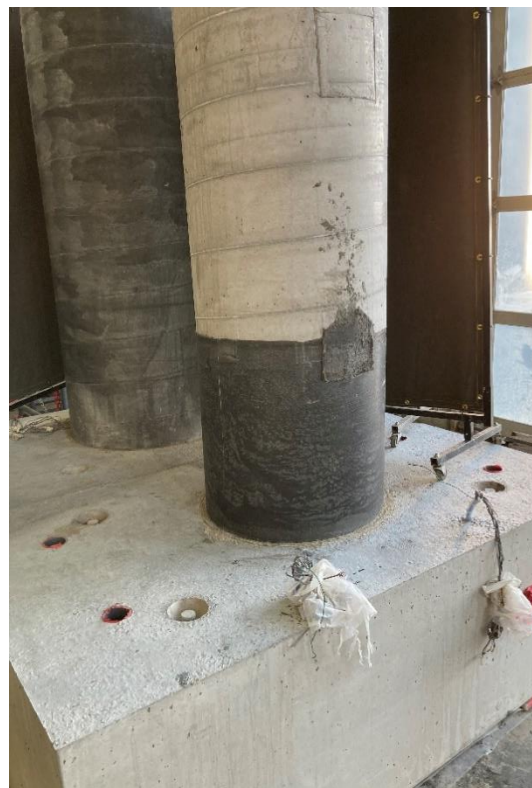
Figure 4-9 Joint BFUP après mûrissement, spécimen P2
