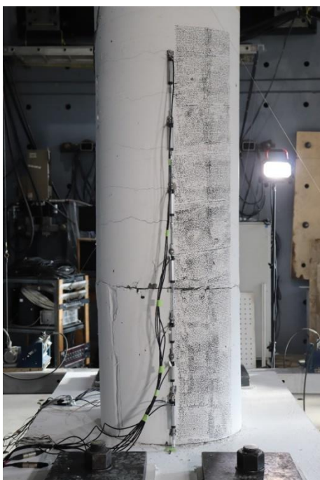
Figure 4-41 Dégradation de la colonne P4 à 2.5\Delta_y et 3\Delta_y
