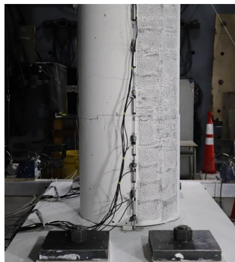
Figure 4-29 Fissuration de la colonne P2 à 2\Delta_y et 2.5\Delta_y
