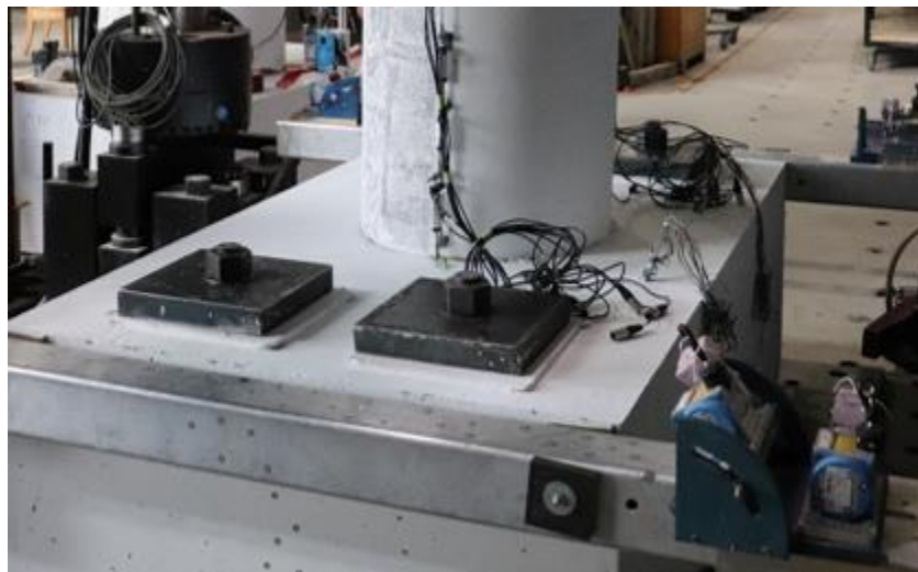
Figure 4-24 Système de potentiomètres à corde installé sur la semelle
