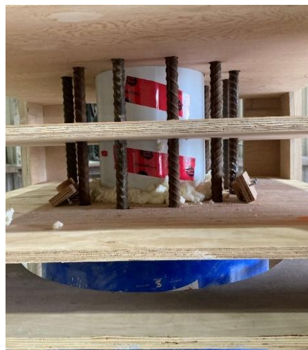
Figure 4-5 Montage du gabarit pour tenir les barres en place
