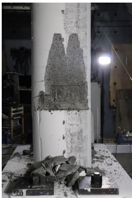
Figure 4-43 Dégradation de la colonne P4 à 5\Delta_y et 6\Delta_y
