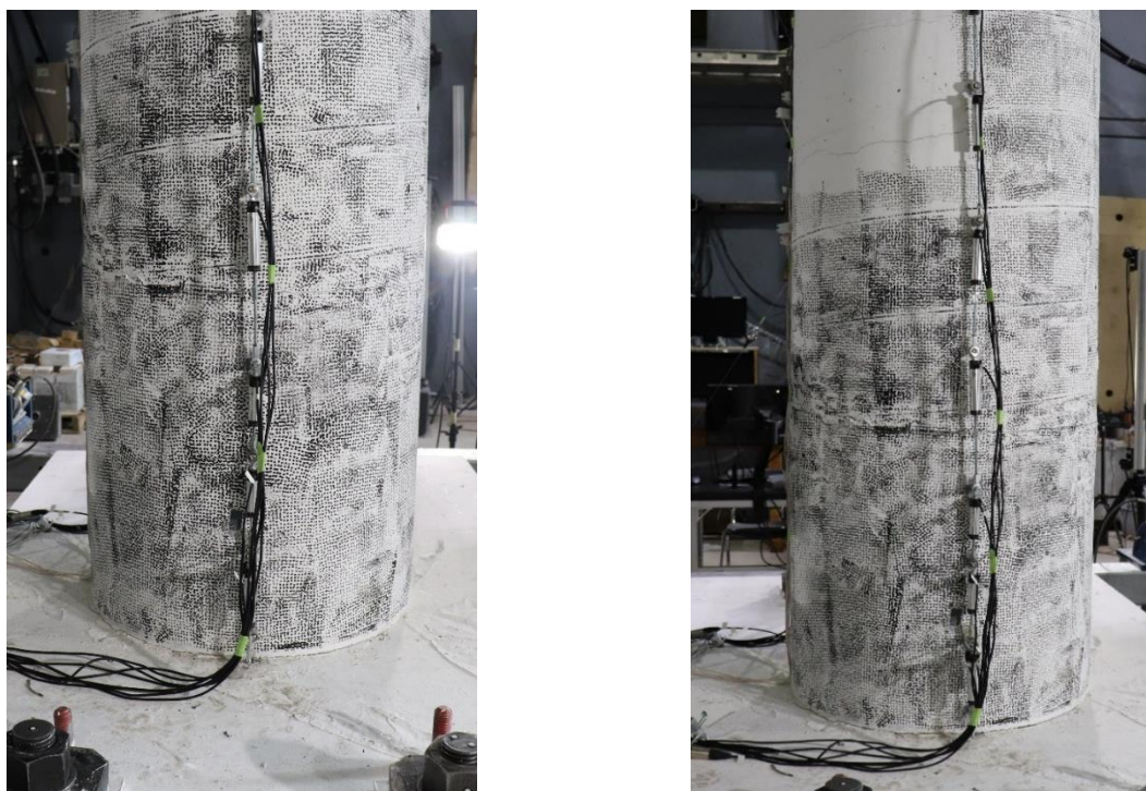
Figure 4-36 Premiers cycles de la colonne P3 à 1\Delta_y et 2\Delta_y
