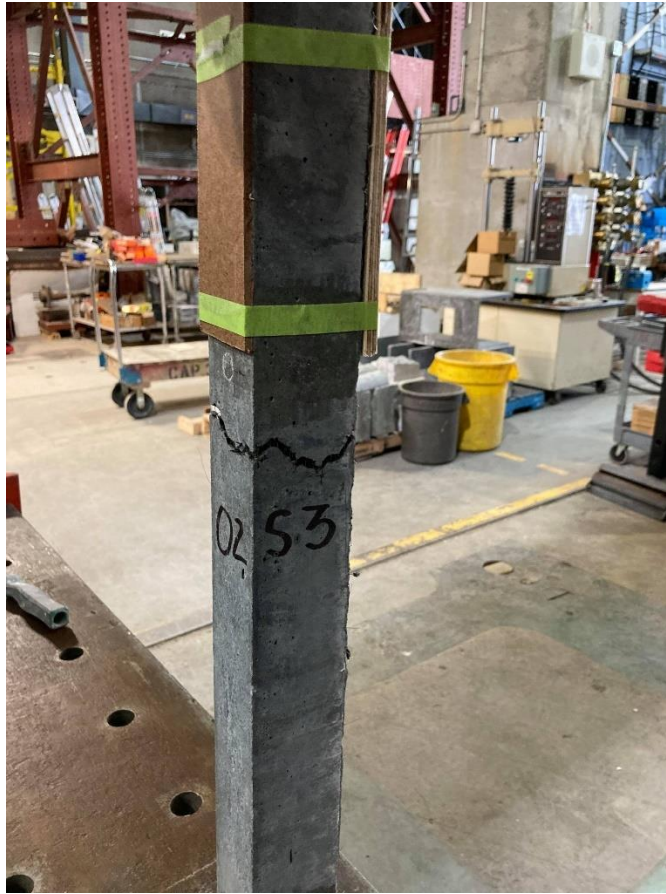
Figure 4-15 Fissure d'un tirant à la suite d'un essai de traction direct
