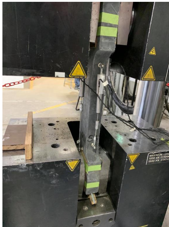
Figure 4-12 Essai de traction directe sur os
