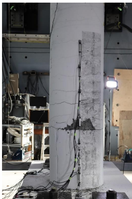
Figure 4-41 Dégradation de la colonne P4 à 2.5\Delta_y et 3\Delta_y
