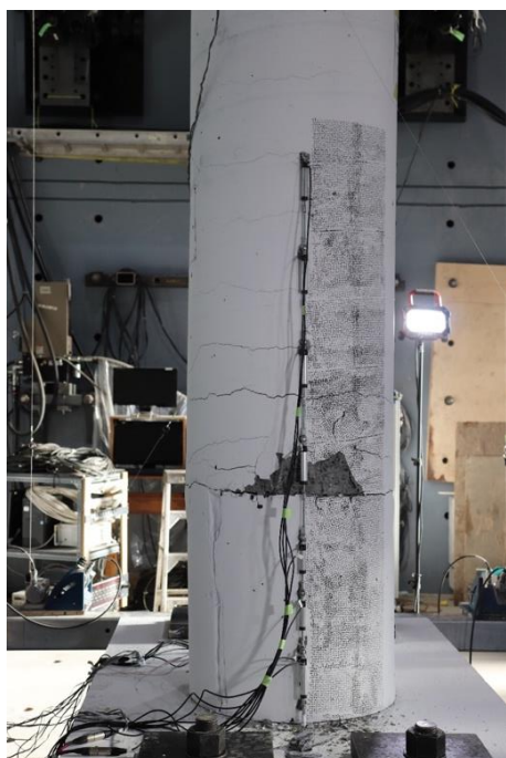
Figure 4-42 Dégradation de la colonne P4 à 3.5\Delta_y et 4\Delta_y
