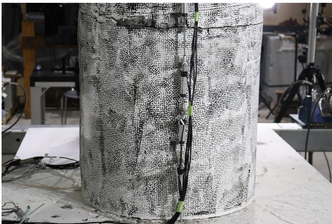
Figure 4-37 Ouverture du joint froid de la colonne P3 à 3\Delta_y
