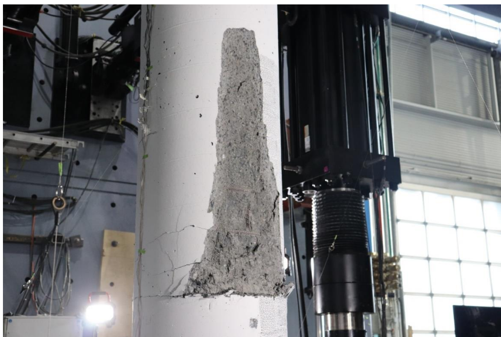
Figure 4-33 Dégradation de la colonne P2 à 6\Delta_y
