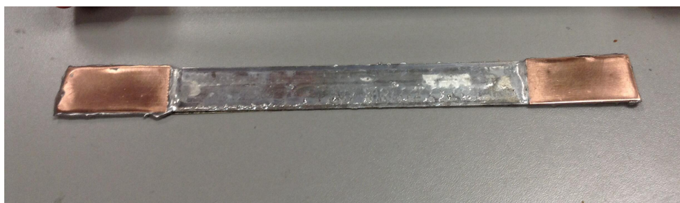
Figure 3.22 Contacts de cuivre soudés au Ruban FG-EPM-015-1 avec shunt.
