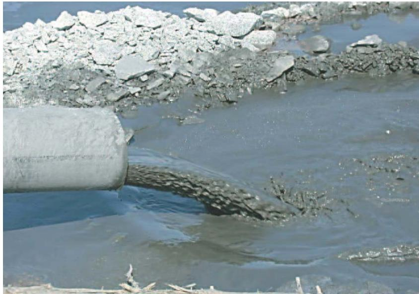
Figure 2.1: Déposition des résidus miniers en bout de tuyau dans un parc à résidus (tiré de Bussière, 2007; photo fournie par la Chaire)
