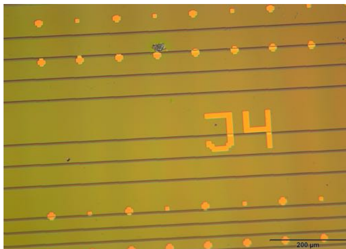
Figure 5.4 Image de microscopie optique montrant les tranchées obtenues après lithographie par faisceau d'électrons et développement.
