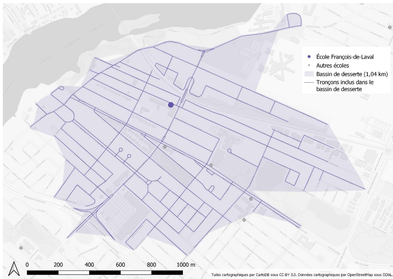
Figure 7.21 Exemple d'un bassin de desserte piétonne : bassin de l'école primaire François-de-Laval, située dans l'arrondissement d'Ahuntsic-Cartierville
