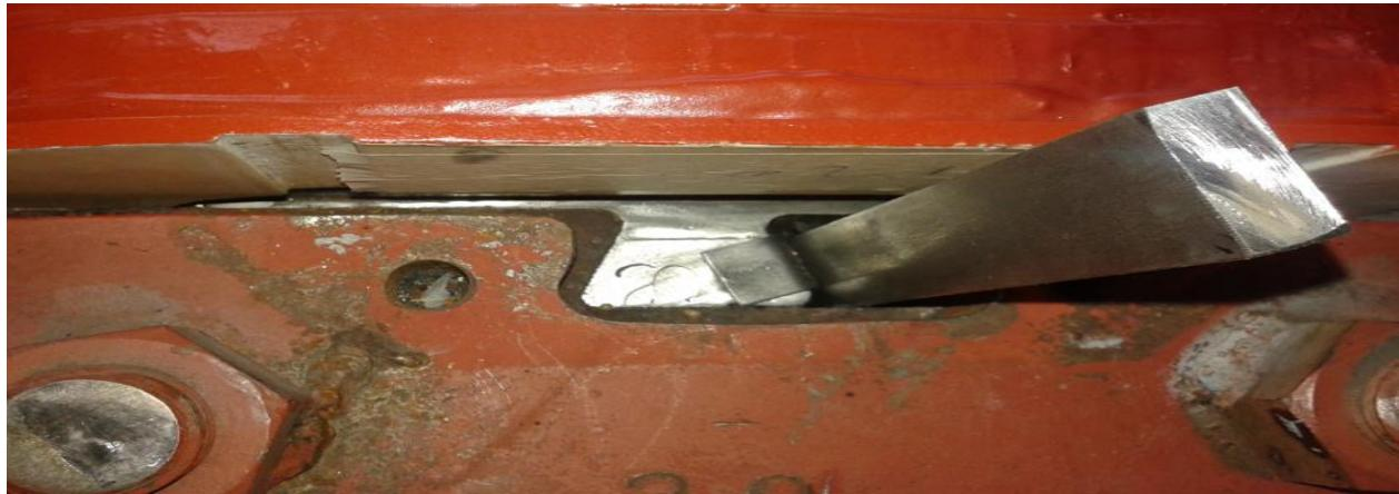
Figure 3.4 Cale de serrage et de blocage en acier en forme de «V»
