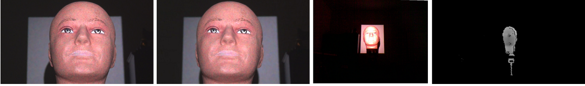
Figure 6.5 Ensemble des données capturées pour une scène numérisée, nos deux vues présentent par la Sony à 60 images par secondes (gauche et centre gauche) et la Kinect, à 30 images par secondes, en couleur (centre droit) et en profondeur (droite).
