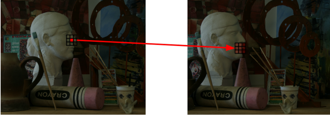
Figure 4.1 Une fenêtre est construite autour de notre pixel d'intérêt (rouge opaque) dans notre première vue (gauche) et on cherche la meilleure correspondance (fenêtre rosée) dans l'autre vue (droite)
