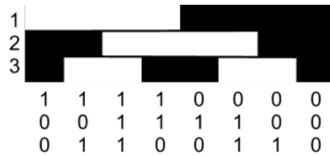
Figure 3.1 Schémas projetés au fil du temps et décodage.
