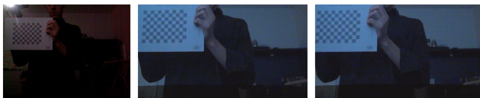
Figure 6.4 Capture d'échiquiers "flashé" par la kinect (à gauche), le capteur stéréo de gauche (au centre) et celui de droite (à droite).
