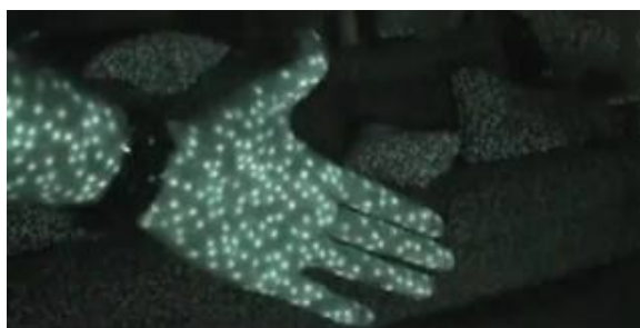
Figure 6.2 Schéma Infrarouge pseudoaléatoire projeté par la kinect (extrait de http://www.youtube.com/watch?feature=player_embedded&v=nvvQJxgykcU ).
