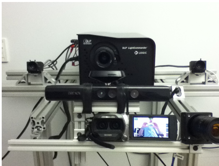
Figure 3.2 Montage comprenant un projecteur, une caméra stéréoscopique pour la numérisation par lumière structurée et une kinect pour de futures expériences.
