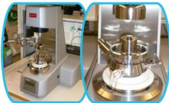
Figure 2.1 – Rhéomètre avec cellule sous-pression d’Anton-Paar Canada Canada, modèle MCR 501
