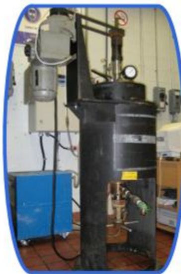
Figure 2.3 – Cuve agitée avec capacité de 38 L (Autoclave Engineers Inc.)
