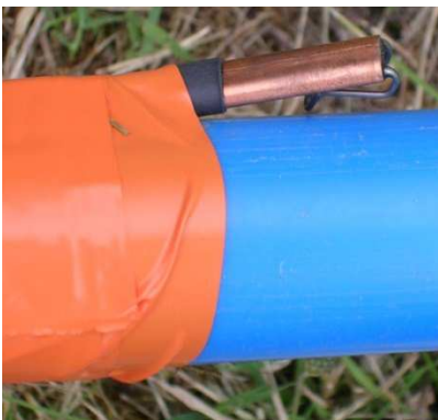
Figure 3.17 : Fixation typique d'une sonde PT-100 dans le puits d'instrumentation
