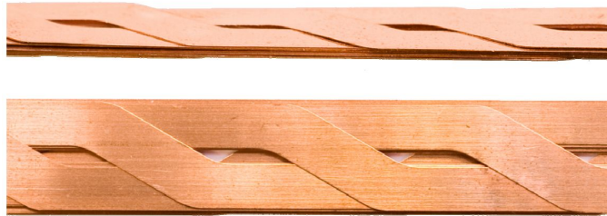
Figure 2.23: Photographie d'un câble Roebel [25].
