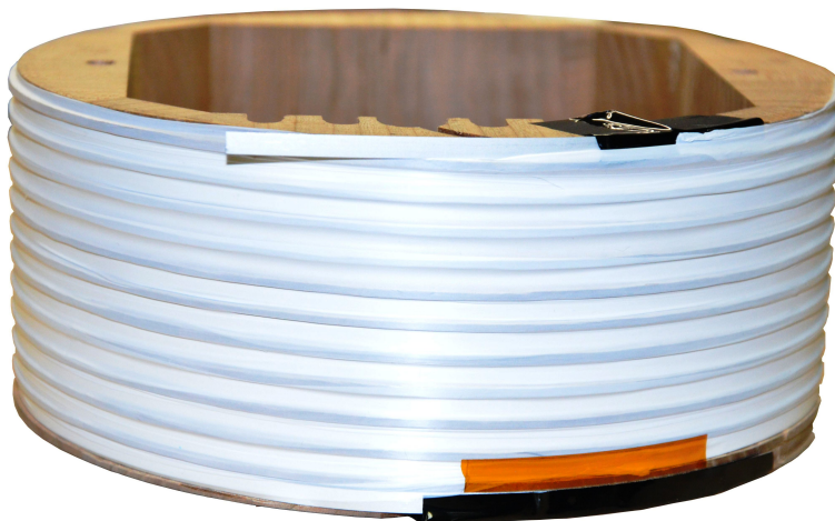
Figure 4.11: Ruban supraconducteur enroulé sur son support puis recouvert d'une couche de téflon pour le protéger.
