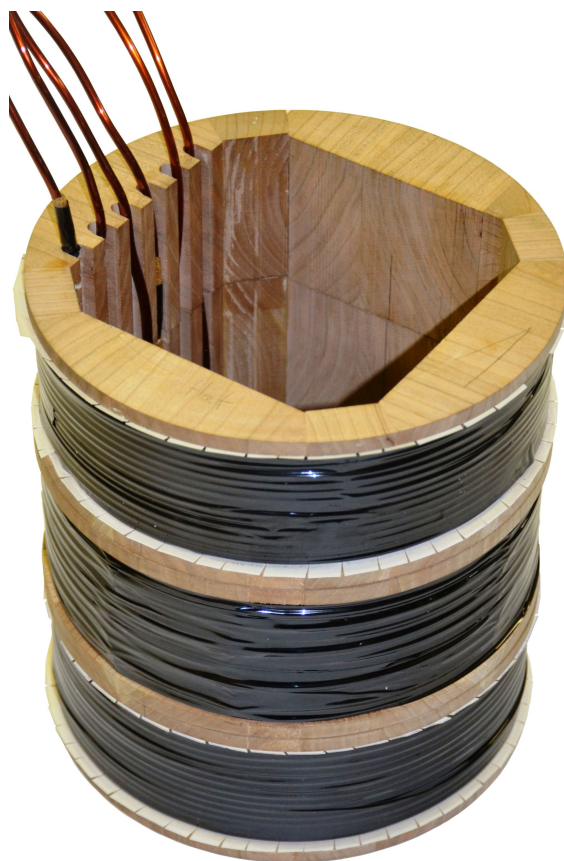
Figure 4.15: Vues des 3 bobines secondaires empilées et emboîtées.
