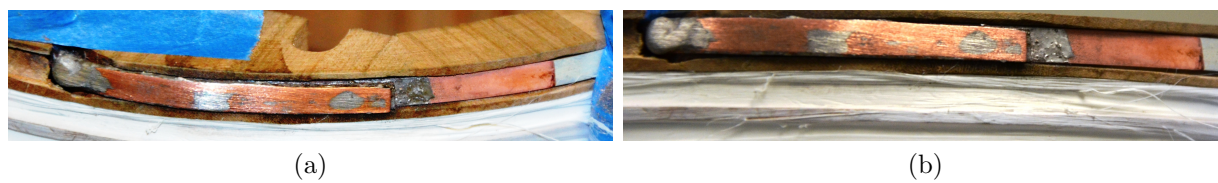
Figure 4.14: Soudure de l'amenée de courant en cuivre sur le ruban supraconducteur.
