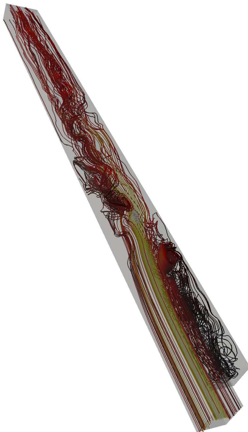
Figure 10.10 Lignes de courant de l'écoulement (gradation de faible à élevée suivant les couleurs noir, rouge, jaune et blanc).
