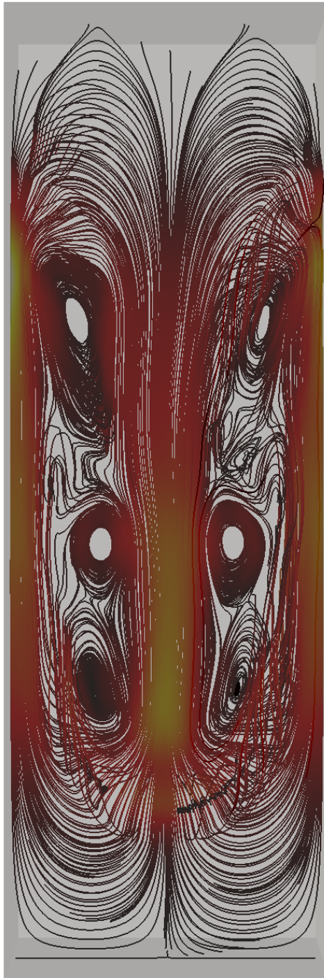
Figure 11.8 Lignes de courant de l'instabilité de Rayleigh-Taylor turbulente à t = 6,5 (gradation de faible à élevée suivant les couleurs noir, rouge, jaune et blanc).
