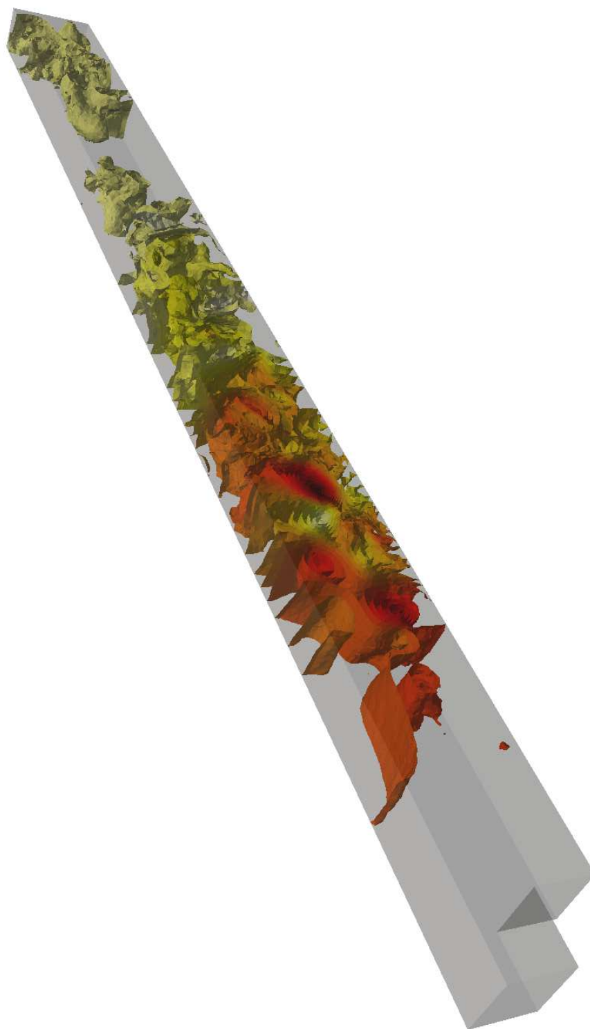
Figure 10.8 Surfaces de niveau de la pression (gradation de faible à élevée suivant les couleurs noir, rouge, jaune et blanc).
