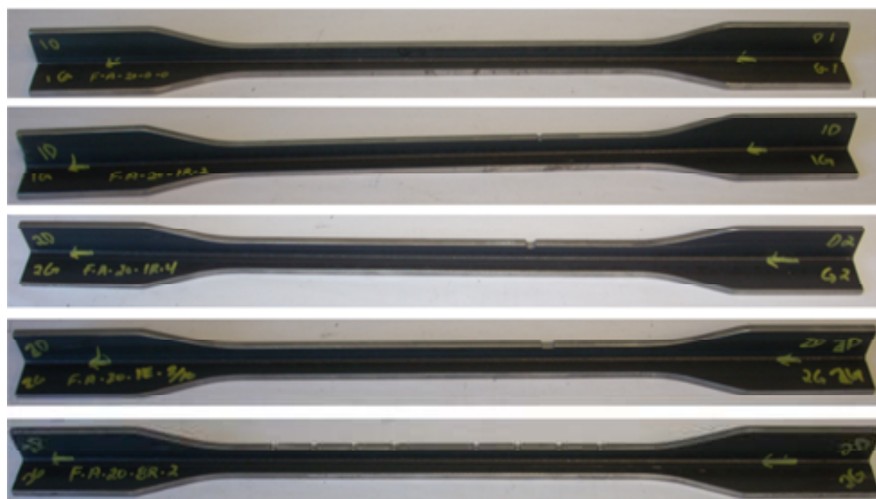
Figure 4.4: Fabrication finale des cornières du programme A
