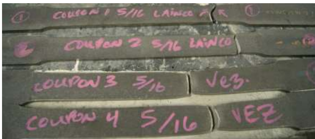
Figure 3.17: Rupture des coupons 1 à 4, C-B-P313
