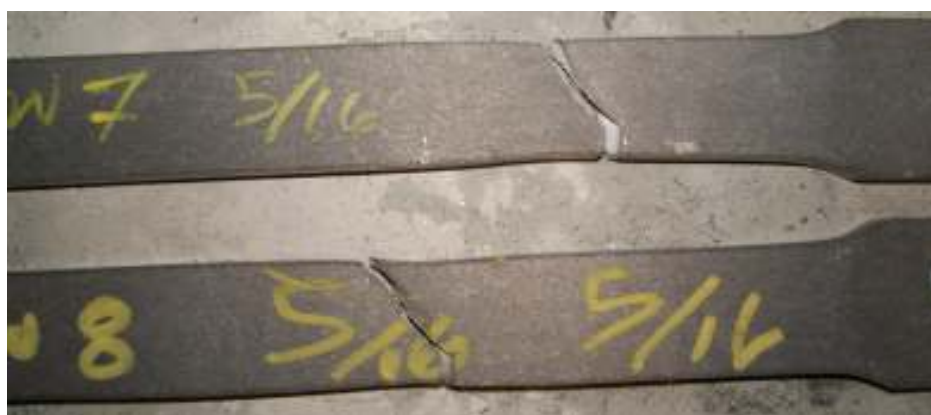
Figure 3.19: Détail de la rupture des coupons 5 et 6, C-B-P313
