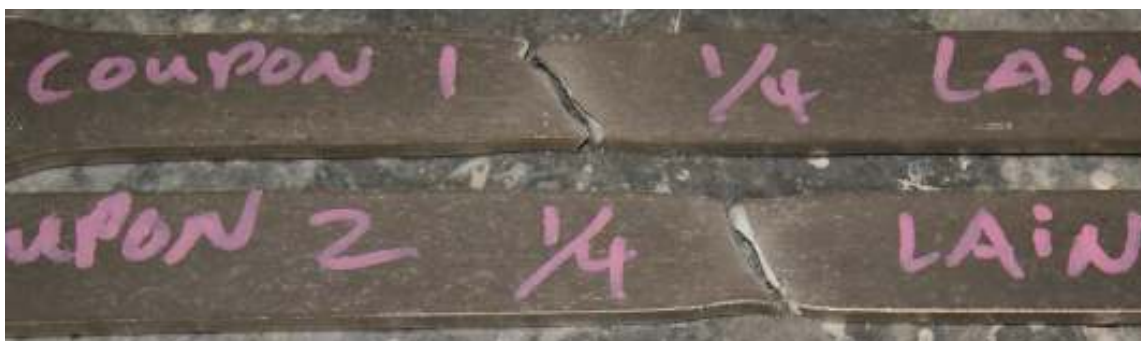
Figure 3.22: Détail de la rupture des coupons 1 et 2, C-B-P250
