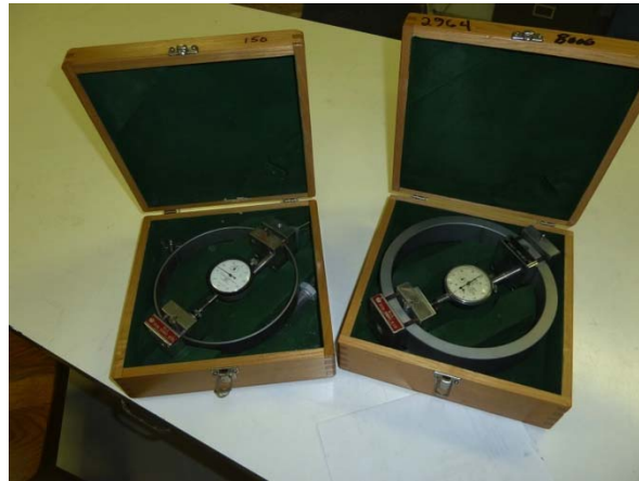
Figure A3.3 : Anneaux de chargement utilisés pour valider les données fournies par les cellules de chargement.
