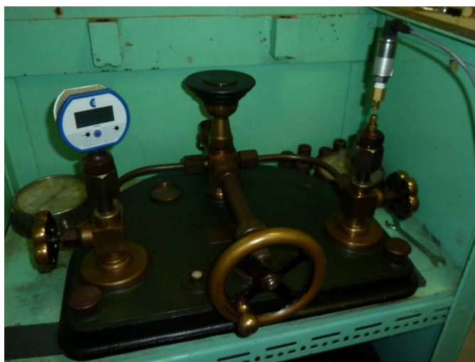
Figure A3.1 : Système de contrôle de pression avec piston de chargement sans friction
