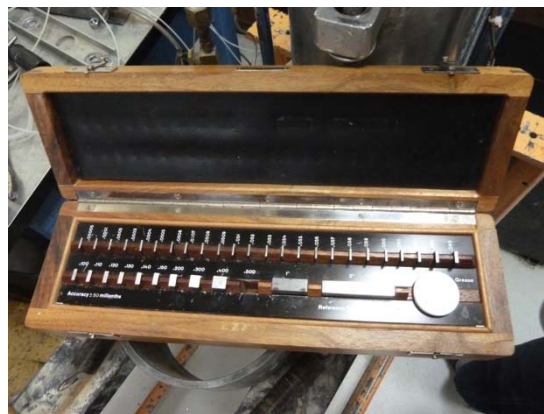
Figure A3.4 : Cales étalons utilisées pour valider la lecture du LVDT
