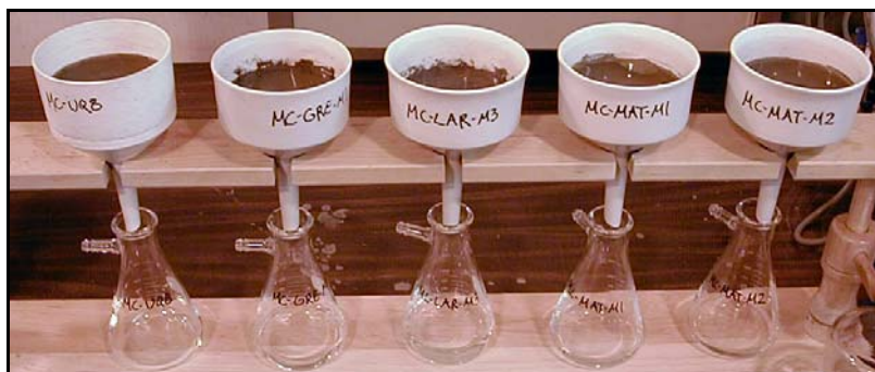
Figure 3.6 : Photographie du montage de mini-cellules d'altération
