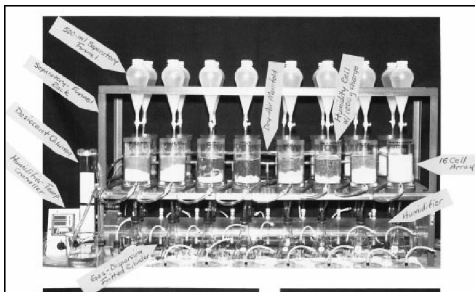
Figure 2.7 : Photographie d'un montage utilisé pour la méthode ASTM 5744-96 (tirée de ASTM, 1998)
