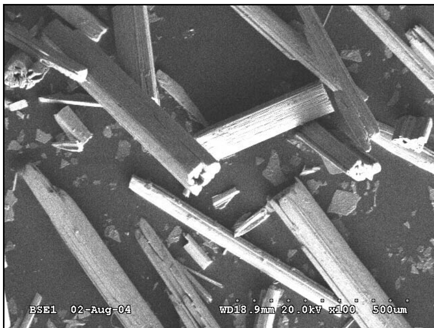
Figure 6.7 : Image en mode électrons rétrodiffusés d'un précipité obtenu en extracteur de Soxhlet modifié obtenue au MEB
