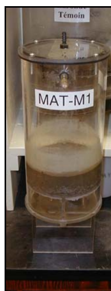
Figure 3.3 : Photographie de la cellule d'humidité MAT-M1
