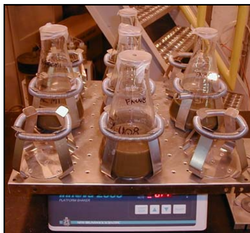
Figure 3.4 : Photographie du montage pour l'essai en flacons agités par échantillonnages compensés
