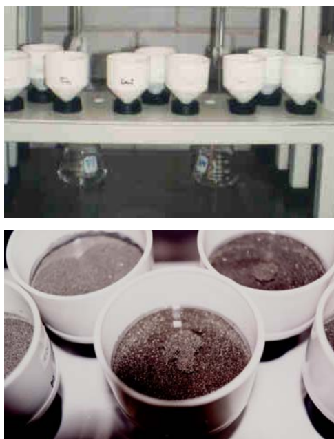
Figure 2.9 : Photographies des montages des essais en mini-cellules d'altération (Monroy, 2002)
