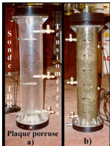
Figure 3.2 : Exemple de colonne instrumentée a) avant et b) après la mise en place de l'échantillon
