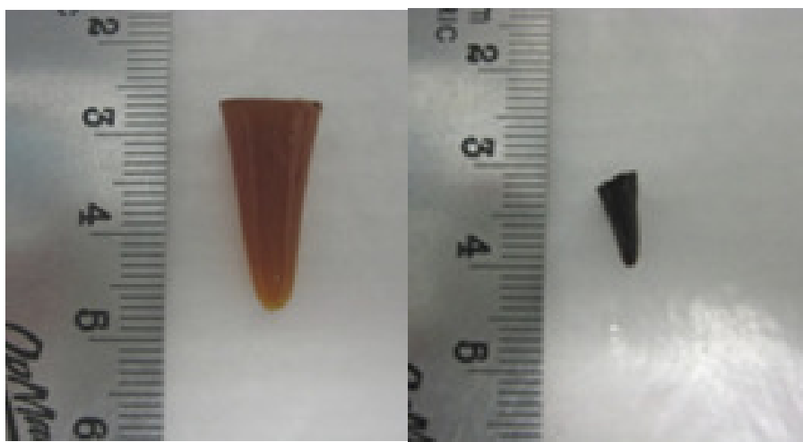
Figure 5.15: Photo de l'hydrogel chargé de nanoparticules, après stabilisation à T = 23^{\circ}\text{C} ( T < \text{LCST} ) et à T = 37^{\circ}\text{C} ( T > \text{LCST} ).
