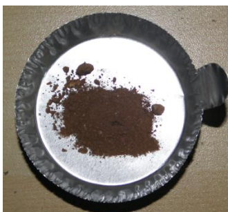
Figure 5.3: Produit de la réaction d'azoturation du polyester-BNPD
