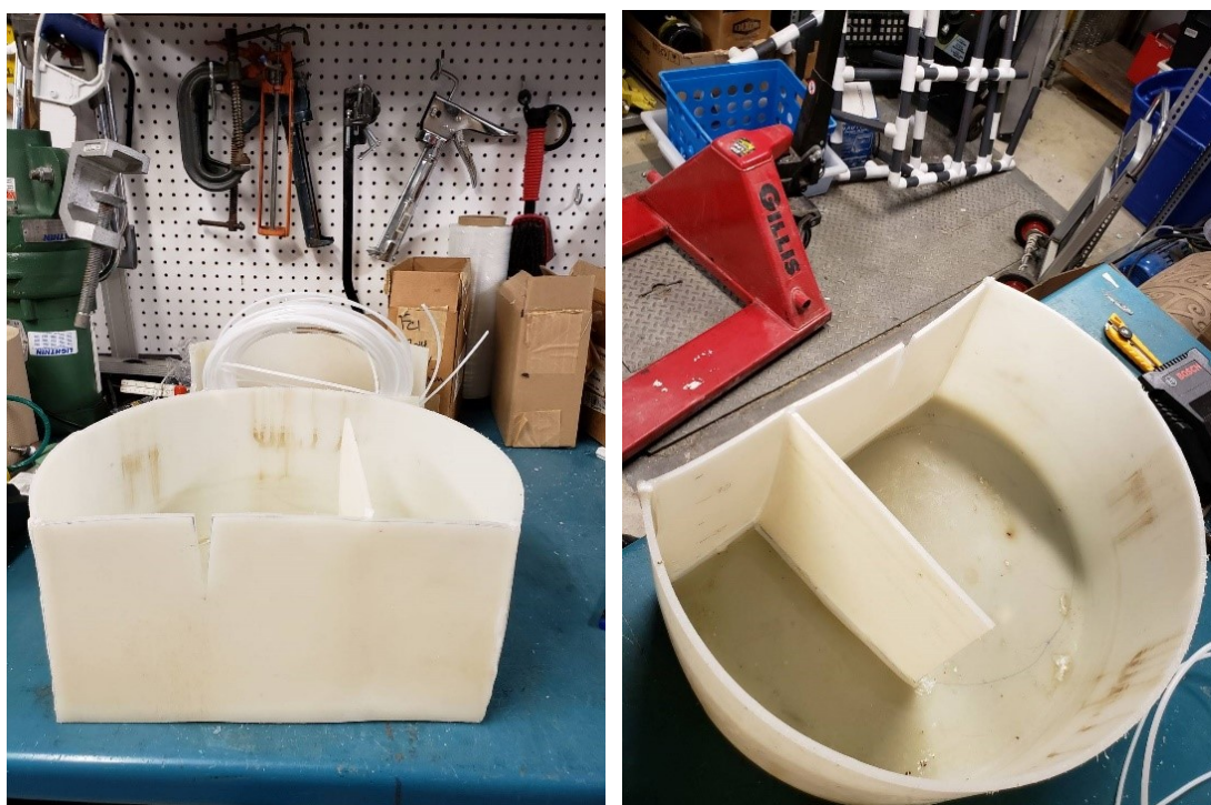
Figure 3.9: Déversoir de sortie
