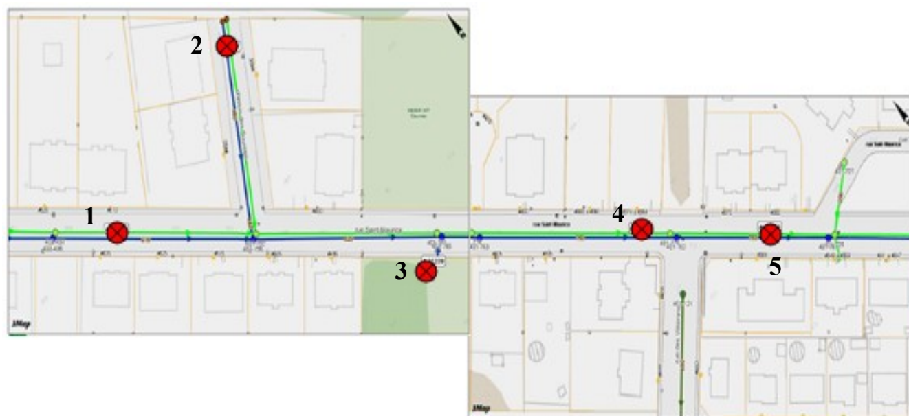
Figure 4.7: Positionnement des débitmètres de Polytechnique Montréal
