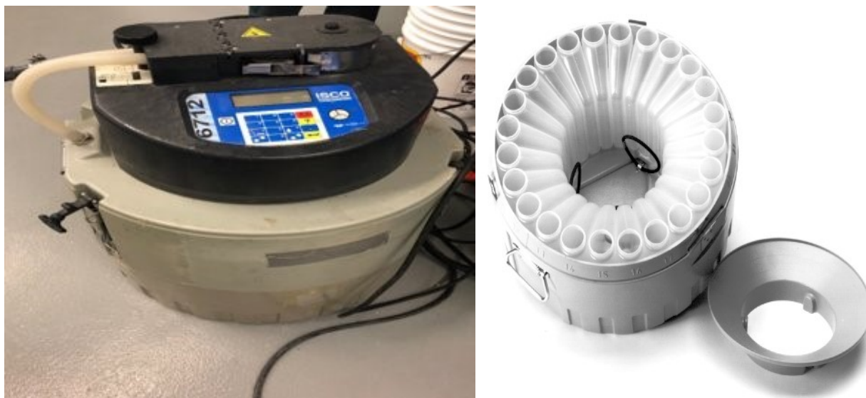
Figure 3.10: Échantillonneur automatique (Source : Teledyne ISCO, 2009)
