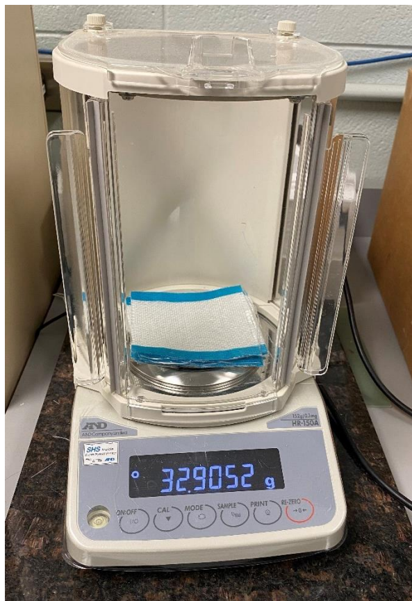
Figure C-6. Balance de précision utilisée pour peser les échantillons de compressibilité
