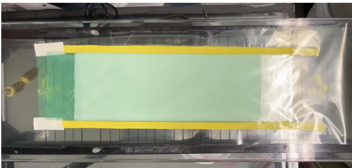
Figure D-7. Drapage du renfort et du milieu drainant à la fin de l'étape 4
