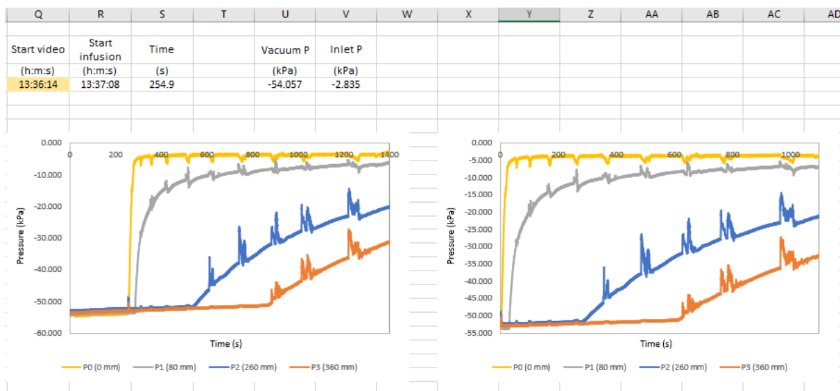
Figure E-2. Évolution des pressions mesurées lors de l’acquisition de données (gauche) et de l’infusion (droite)
