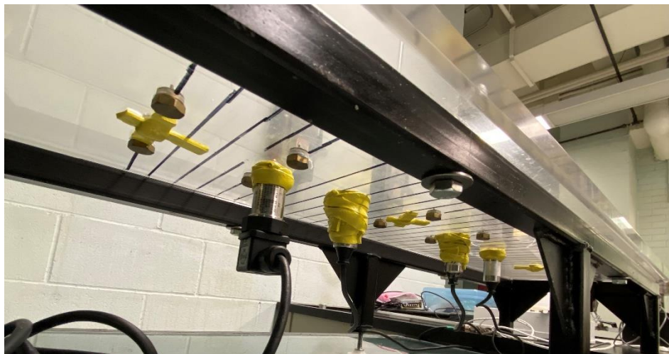
Figure 4-10. Photographie des capteurs de pression disposés sous la plaque de plexiglas
