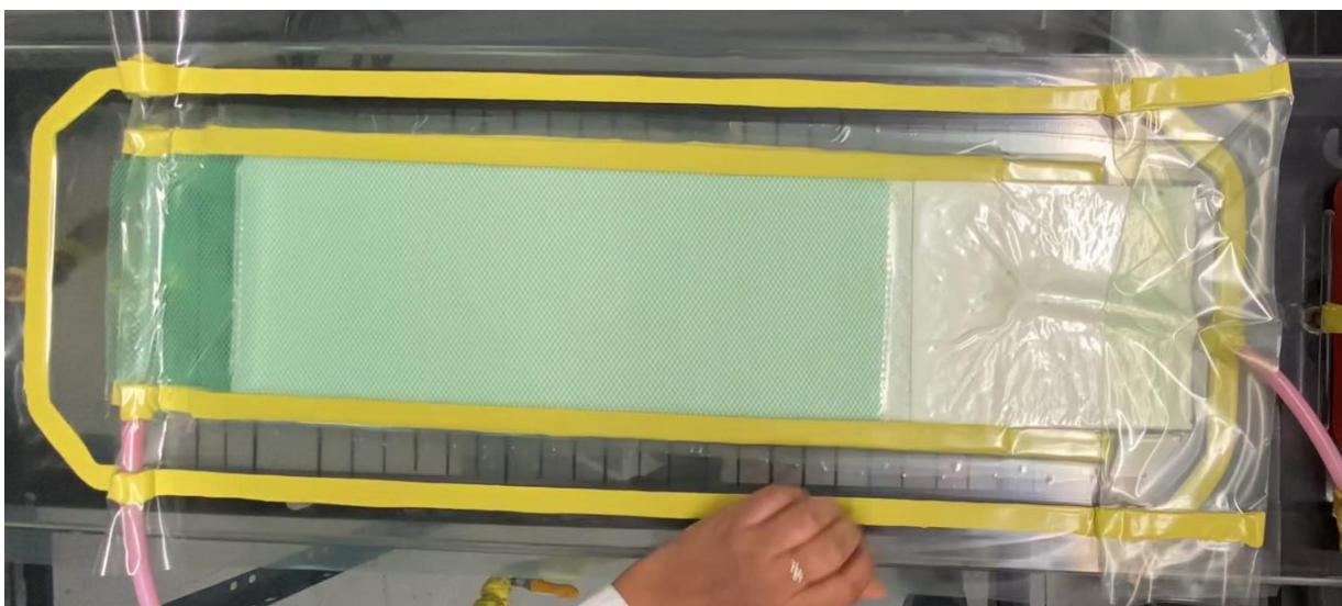
Figure D-14. Montage expérimental après que le vide est tiré dans la cavité
