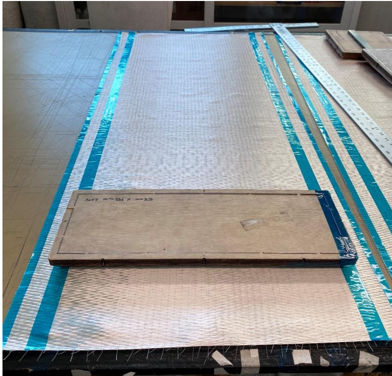
Figure D-1. Découpe des échantillons à infuser
