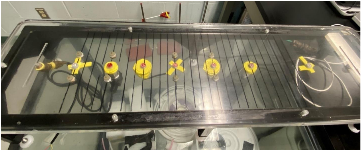
Figure 4-9. Photographie de la plaque de plexiglas utilisée comme moule d'infusion
