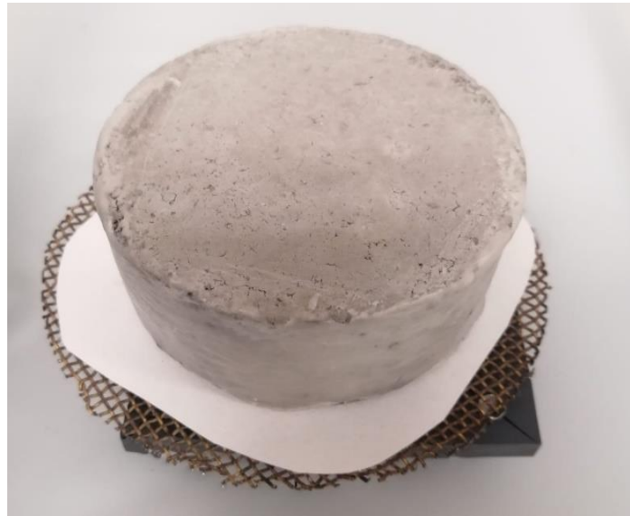
Figure 3.13: Échantillon d'argile traitée mis sur un grillage et un papier filtre.
