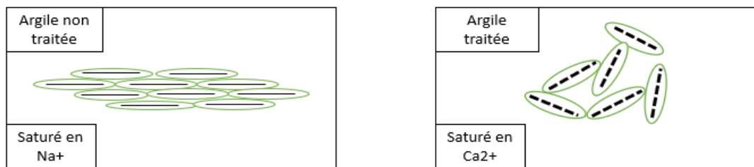
Figure 2.7: La structure microscopique d'une argile non traitée et celle traitée à la chaux. Adapté de (Little, 1987).
