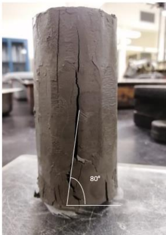
Figure 3.5: Plan de rupture à la suite de l'essai de compression simple.
