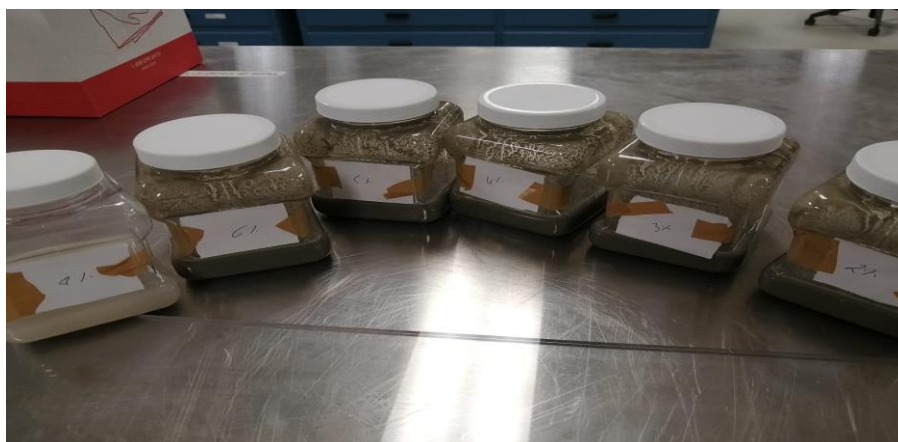
Figure 3.8: Six boîtes secouées prêtes pour la mesure de pH.
