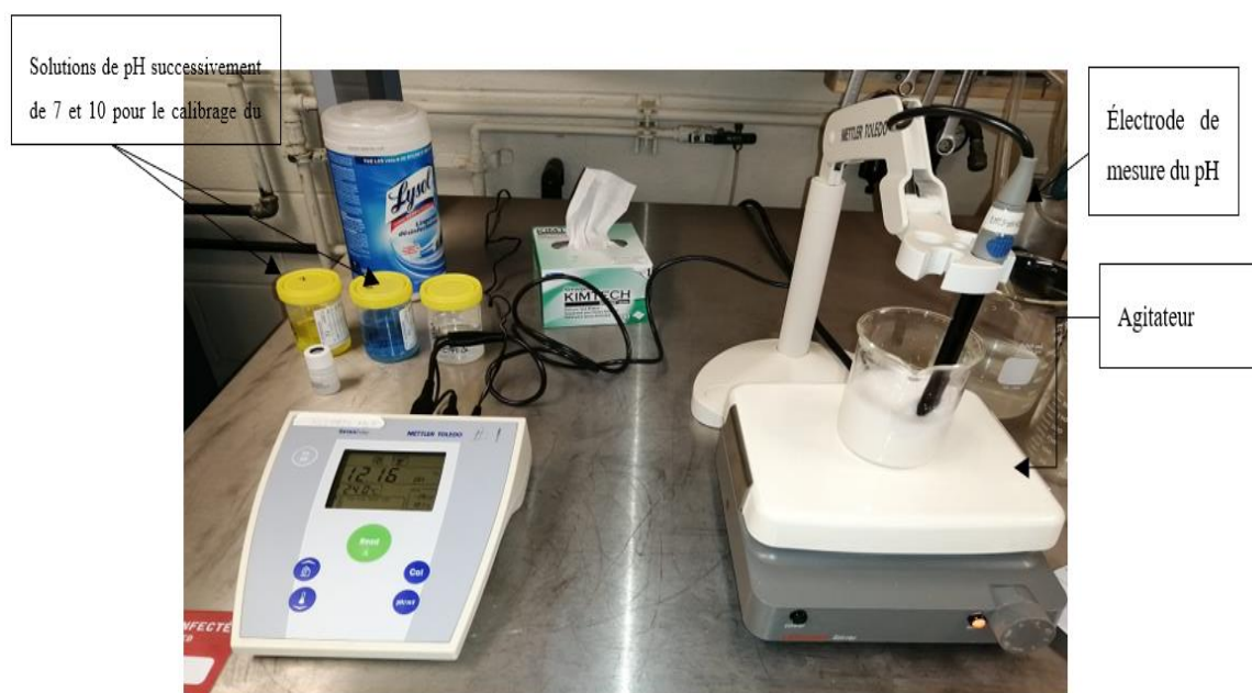
Figure 3.9: Mode opératoire de l'essai PFC.
