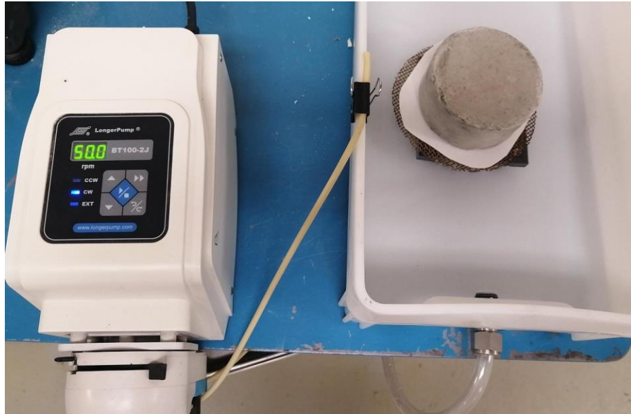
Figure 3.15: Mode opératoire de l'essai d'absorption d'eau avec immersion.
