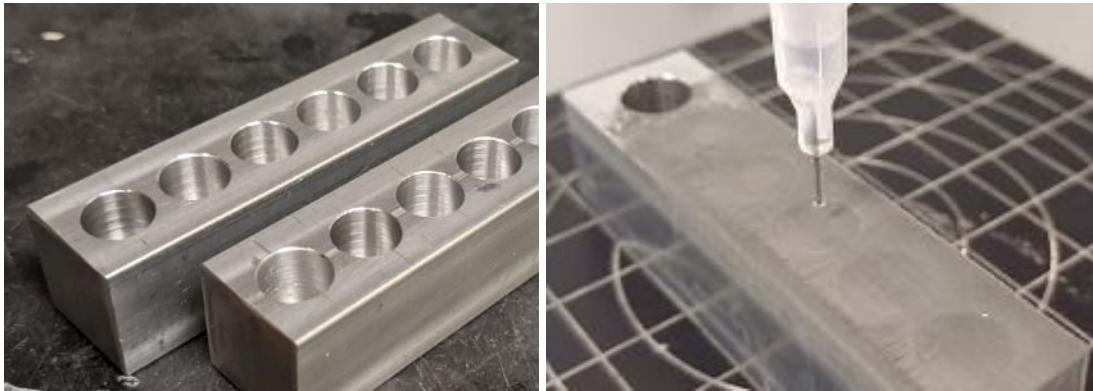
Figure 3.3. Supports à trous pour contenir la poudre, vides (gauche) et lors d'une expérience (droit).
