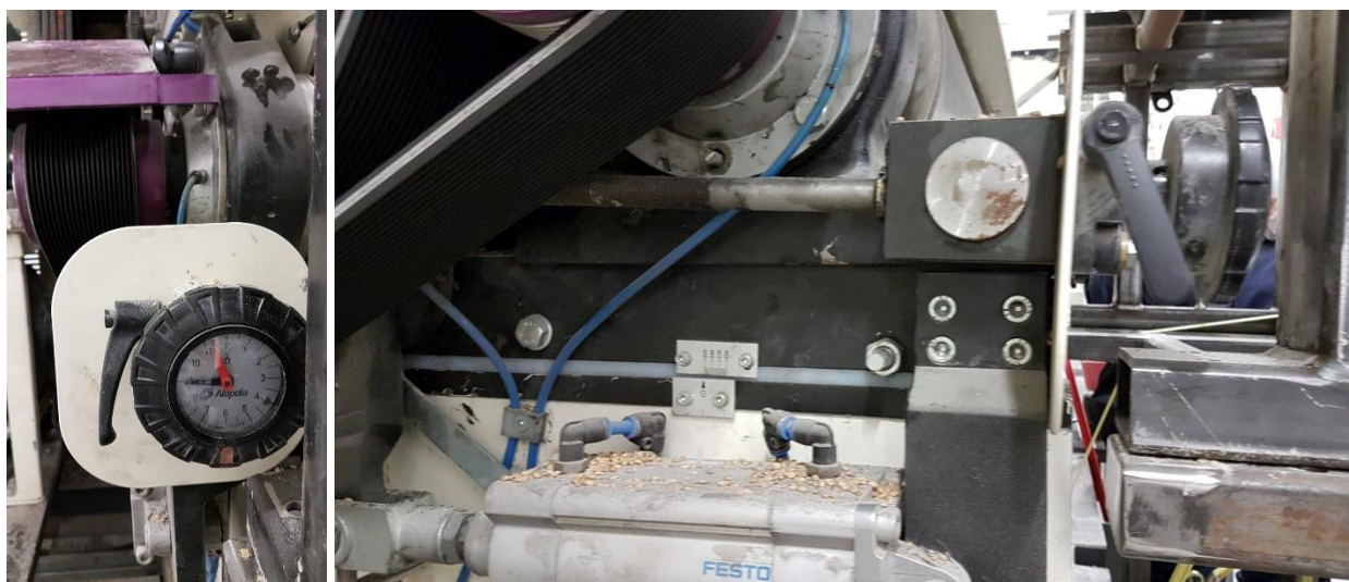
Figure 5-19 : Photos du système mécanique de réglage des rouleaux de broyage
