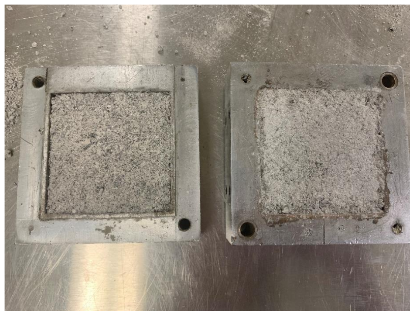
Figure 5-2: Plan de rupture d'un d'échantillon soumis à l'essai de cisaillement direct
