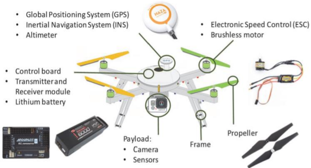
Figure 2.12 Composantes typiques d'un drone (Daponté et al., 2017)
