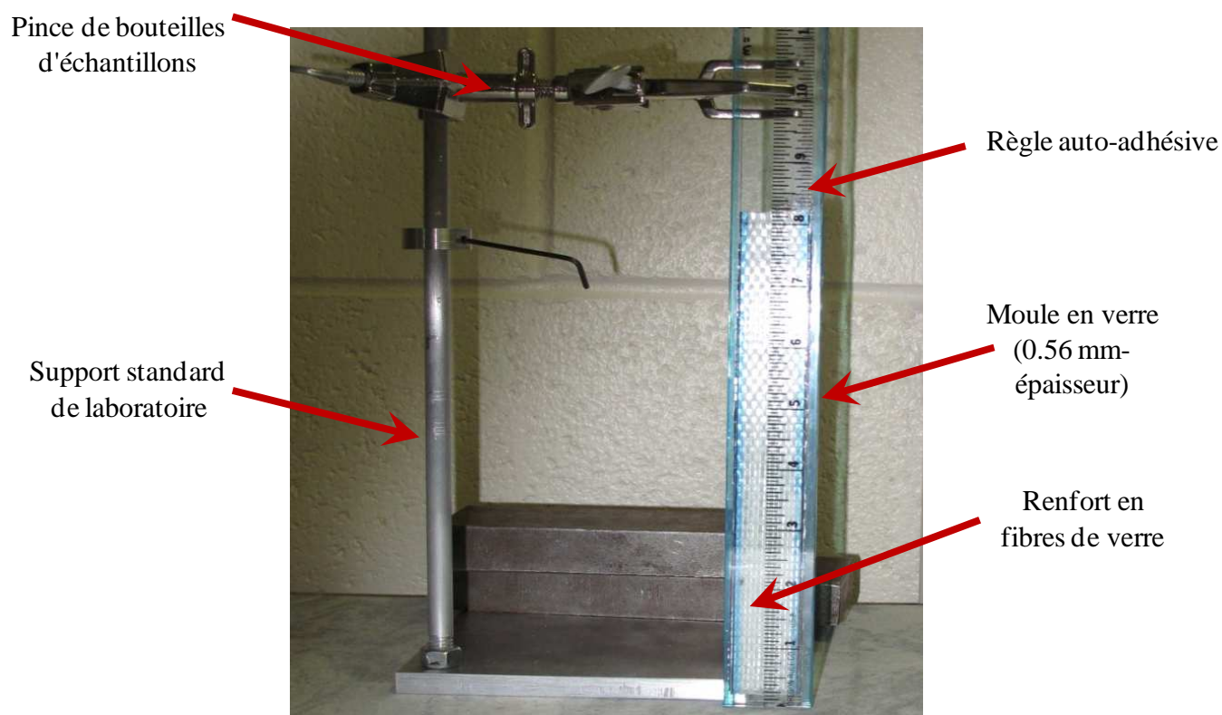
Figure 2-11 : Mise en place du renfort pour les expériences de montée capillaire.
