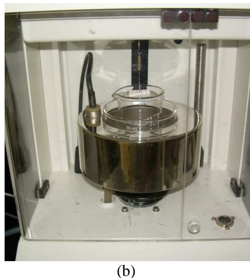
Figure 4-1 : Mesure de la tension de surface : (a) schéma descriptif de la méthode de la lame; (b) tensiomètre K14 de Krüß [85].
