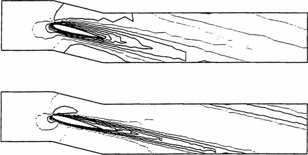
Figure 4.36: Iso de vitesses à 5% pour Beta de  $15^{\circ}$ , Alpha de  $0^{\circ}$  avec Re de 100 et de 1000
