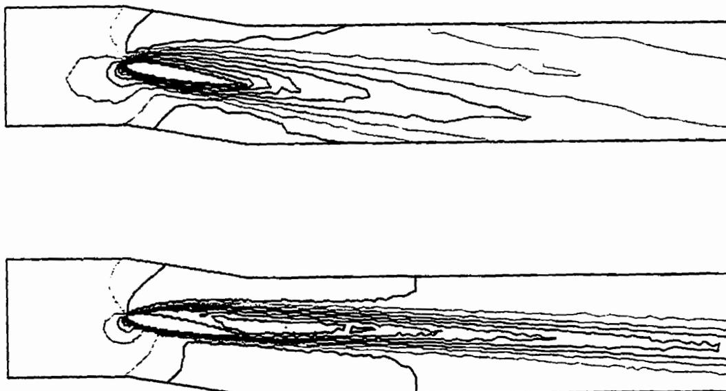
Figure 4.35: Iso de vitesses à 5% pour Beta de  $10^0$ , Alpha de  $15^0$  avec Re de 100 et de 1000
