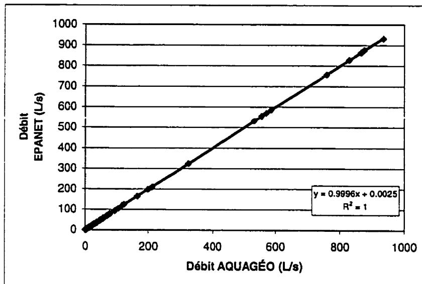
**Figure 3.4 :** Comparaison des résultats relatifs aux débits dans les conduites (EPANET vs AQUAGEO)
