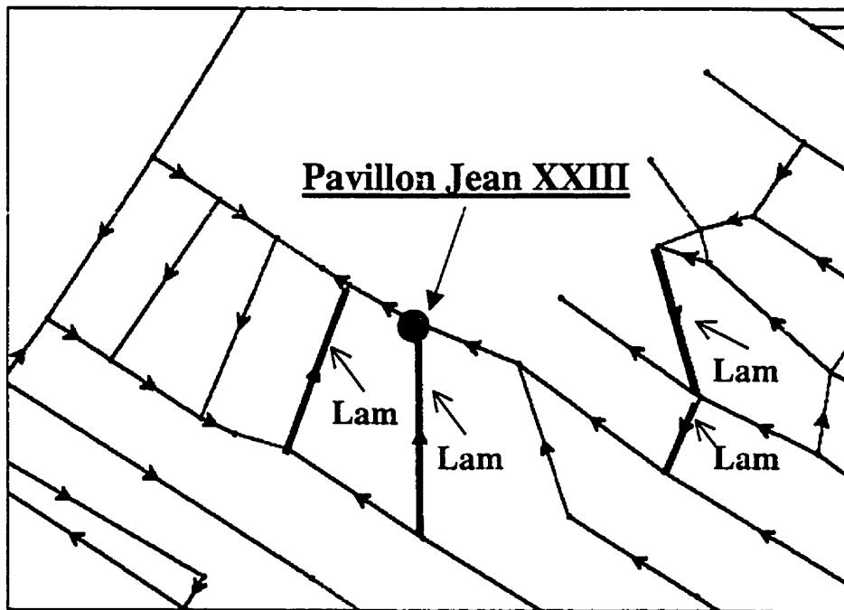
Figure 5.3: Régime d'écoulement dans les conduites avoisinantes de la station d'échantillonnage *Pavillon Jean XXIII*
