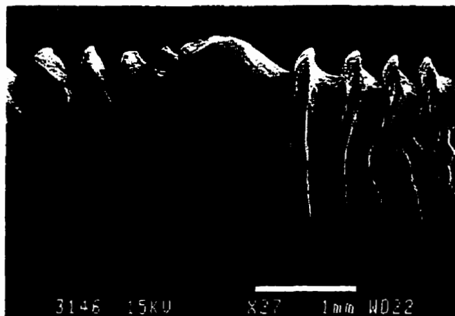
Figure 6.20 Défaut de type oscillant (PEBDL, 190 °C, D=1,6 mm, L/D=16 , entrée plate, \dot{\gamma}_{\text{moy}}=590 \text{ s}^{-1} ).
