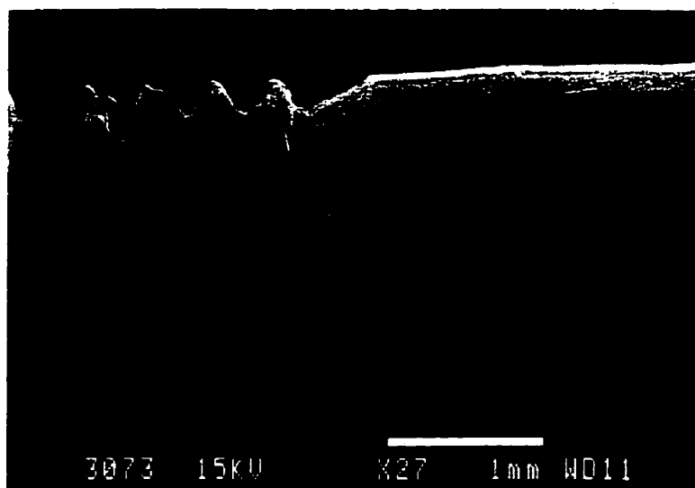
Figure 6.4 Défaut de type oscillant; Passage du segment lisse au segment à peau de requin (PEBDL, 190 °C, D=1,6 mm, L/D=16 , entrée convergente, \dot{\gamma}_{\text{moy}}=544 \text{ s}^{-1} ).
