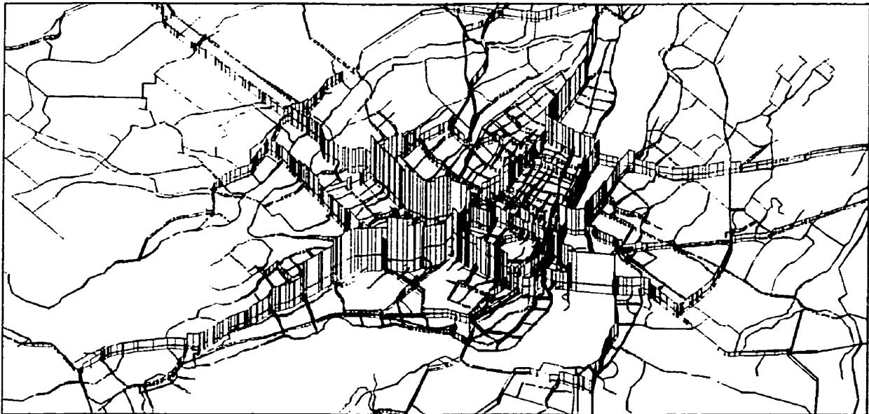
Figure 7.3 : Profil de charge en trois dimensions du réseau routier de la GRM en pointe du matin dans les deux directions
