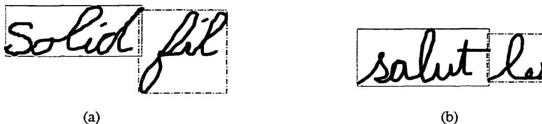
Figure 2.9. Cas problématiques des méthodes de distance entre rectangles. (a) deux mots inclinés, (b) deux mots qui se chevauchent horizontalement.
