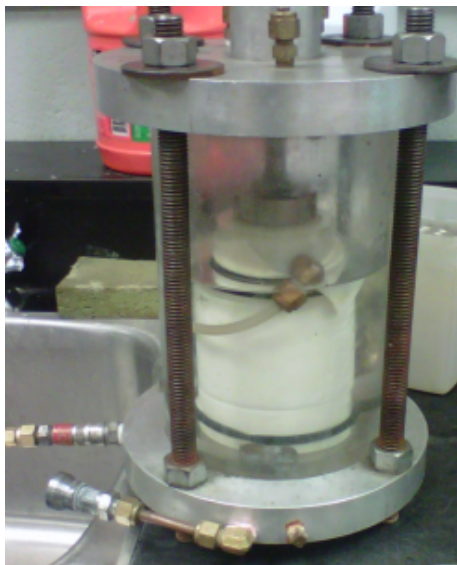
Figure 3-2 : Cellule triaxiale avec l'échantillon de résidus enveloppé dans sa membrane étanche.
