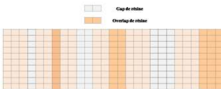
FIGURE 2.5 Modes secondaires : position de gaps et d'overlaps dans le laminé
