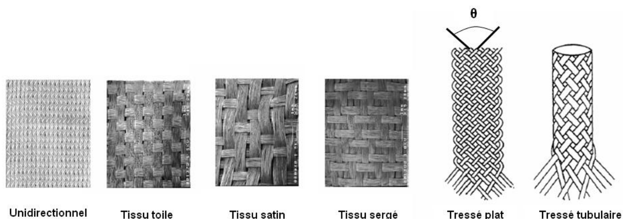
Figure 1 : Exemples d'architecture de renforts fibreux tissés (Feuvrier 2007).
