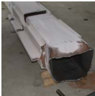
11) Détail de rotule plastique à mi-portée du spécimen RHS14, 12) Section de rupture du spécimen RHS14, 13) Plastification du gousset supérieur du spécimen RHS14.
