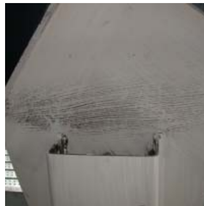
11) Détail de rotule plastique à mi-portée du spécimen RHS14, 12) Section de rupture du spécimen RHS14, 13) Plastification du gousset supérieur du spécimen RHS14.
