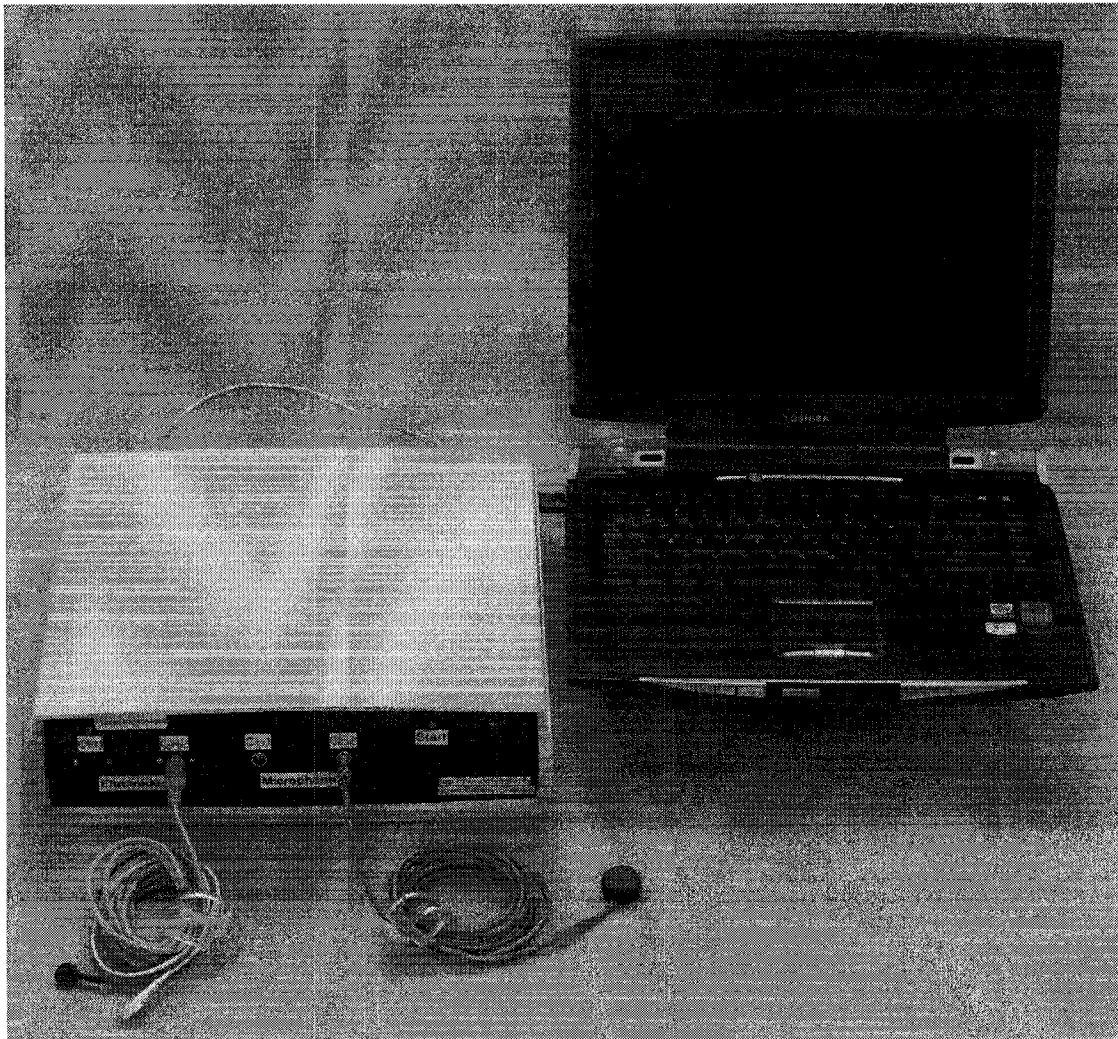
FIG. 3.3 Vue d'ensemble du système de myographie acoustique
