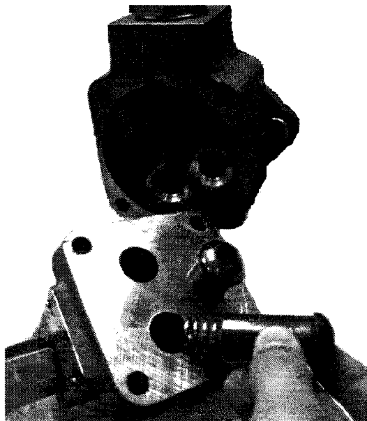
Figure 3.6 : Retrait de pistons de la pompe.
