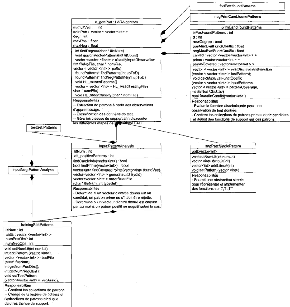
Figure 3.3 Diagramme d'objets de l'algorithme LAD et de classes de support
