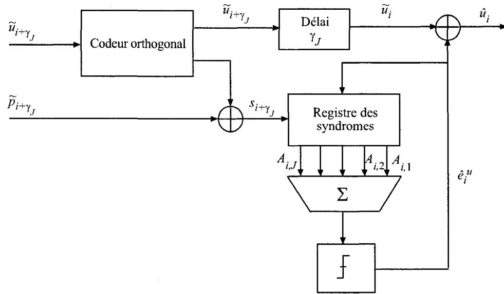
FIG. 1.6 Décodeur à seuil en quantification dure
