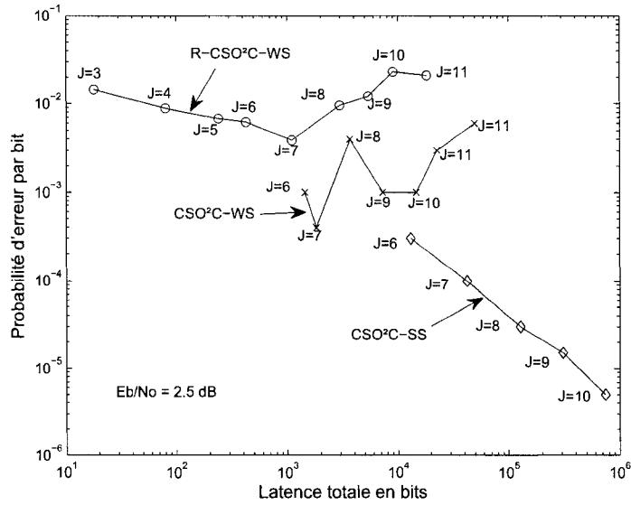
FIG. 3.12 Comparaison des performances d'erreur des codes  $CSO^2C$  et  $R-CSO^2C-WS$  en fonction de la latence totale après convergence en bits avec  $E_b/N_0 = 2.5dB$
