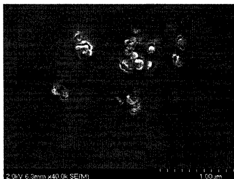
Figure 3. 9 : Nanocomposite préparé par pré-dispersion des NFC dans l'éthanol (0.5 %pds). Surface polie (gauche), Surface fracturée (droite), image MEB haute résolution (bas).
