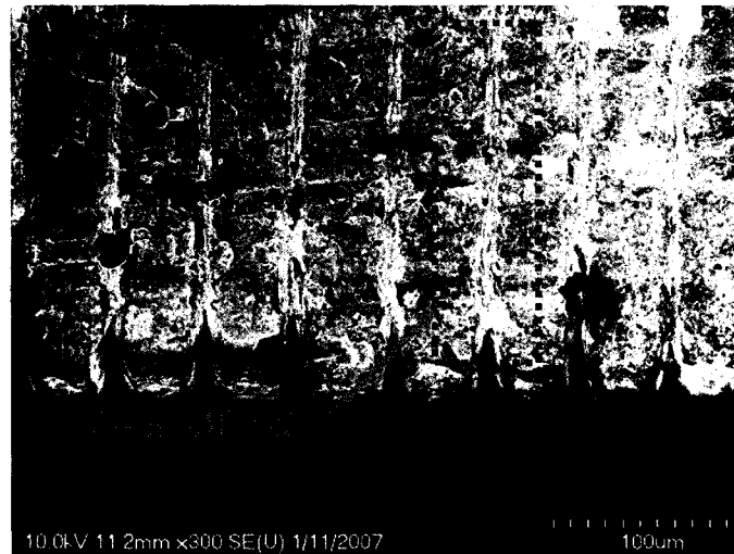
Figure 3.16 : Cliché d'analyse au MEB d'une coupe transverse du réseau de diffraction de ZnSe fabriqué par ablation laser
