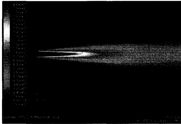
Figure 10 : Simulation numérique du jet turbulent avec FLUENT .
