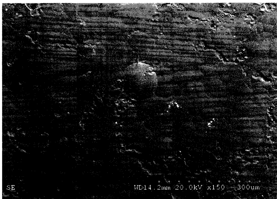
Figure 3.6 : micrographie prise au MEB montrant un nodule de 115 µm beaucoup plus grand que les autres à la surface d'un placage de Co-P (120 µm TT) déposé sur du 4340 ayant subi un test de corrosion en brouillard salin.
