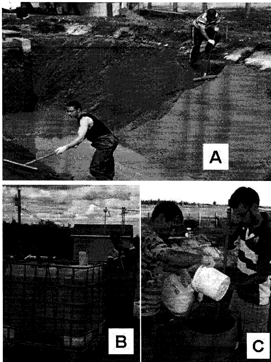
Figure 3.2. Procédure d'échantillonnage des boues des vidanges annuelles des étangs à fond bétonné #1 et #2. A : nettoyage de parois; B : mesure du volume de boues; C : échantillonnage représentatif des boues.
