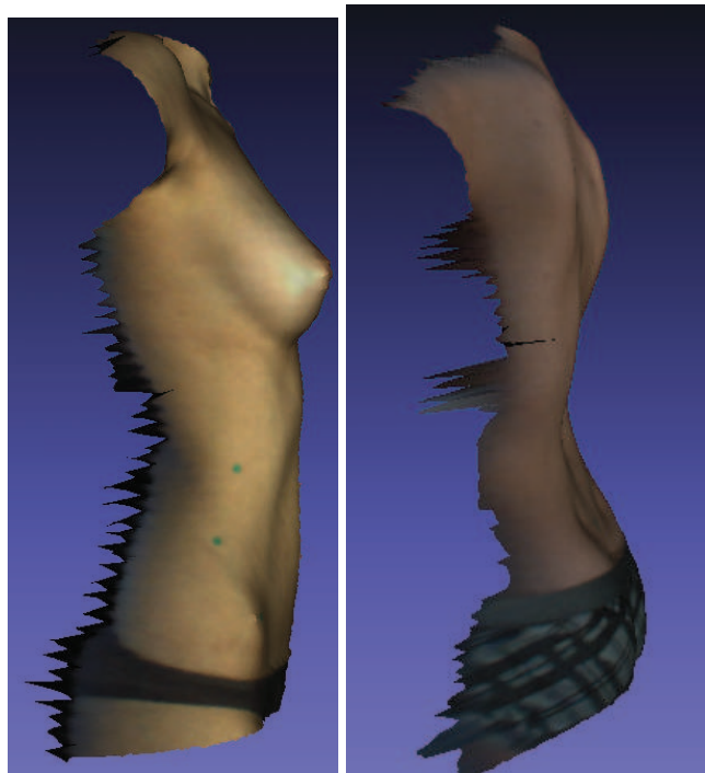
Figure 2.9 Surfaces polygonales montrent des triangles de mauvaise qualité.
