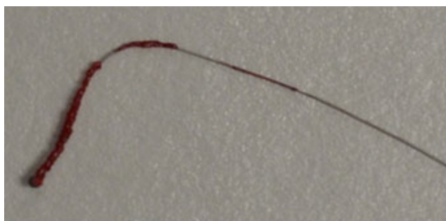
Figure 4.10. Accumulation de fibrine et déformation du guide après les essais sur l'artère iliaque de la cinquième lapine.
