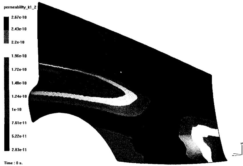
Figure 3.18 Perméabilité locale majeure  $K_1$  estimée avec l'équation (3.14), qui décroît jusqu'à dix fois dans la zone de grande déformation.
