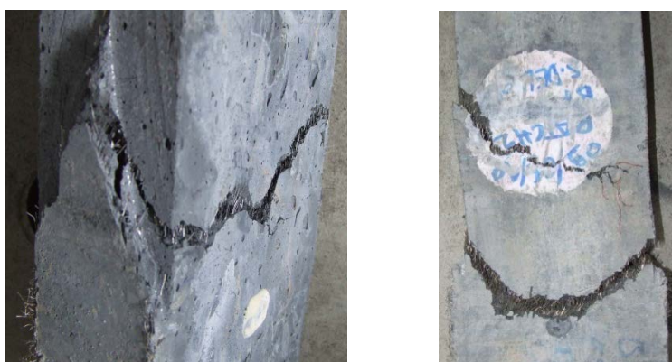
Figure 4-5 : Fissuration au niveau du changement de section sur les spécimens c et d
